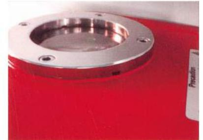
视窗采用聚碳酸酯，内置O型圈，金属压盖固定，压紧自带两个排水槽，不易积水，易观察。
